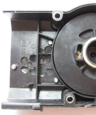
Umriss, Falz und genaue Lage der Löcher des Wasserabweisers auf eine durchsichtige Folie übertragen. Von innen die Schablone so einpassen, dass die 3 späteren Befestigungslöcher nicht durch die Stege gehen; die 3 Löcher anzeichnen (mehrfach prüfen!) und bohren (3,5 mm).
