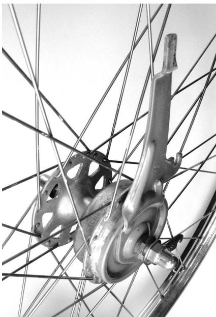
Zunächst das originale Vorderrad\* ausbauen und die Bremsplatte (langer Gegenhebel) lösen.
