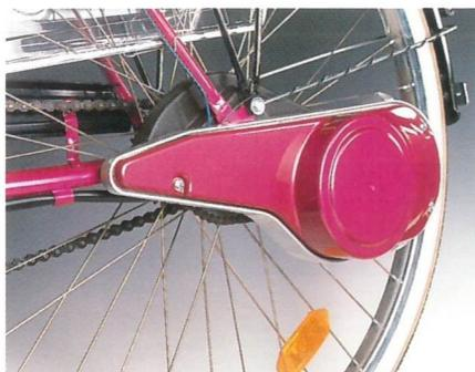
*Der zuschaltbare Gleichstrommotor der HERCULES Electra leistet max. 0,36 KW. So kommen Sie locker auf Touren.*
